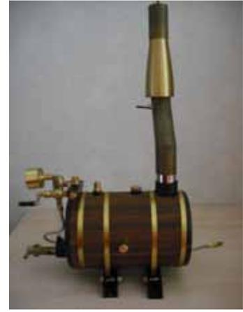
*Dampfkessel mit aufgesetzter Abgasglocke*
