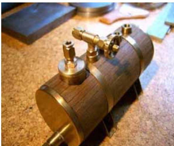
*Kondensatbehälter mit einem Dampfeinlass, drei Dampfablässen und einem Kondensat-Auslassventil*
