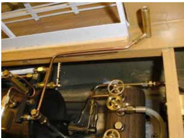
*Speisewasserventil, Kondensatbehälter mit Regelventile für Schornstein/Abdampfkamine*
