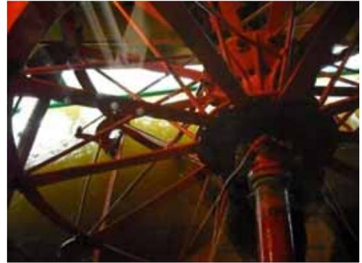
*Die Speichenräder waren ausgerichtet und so konnte die Länge der einzelnen Schaufeln mit 53mm ermittelt werden. Die Schaufelbreite mit 28mm konnte erst beim „Wassertest“ ermittelt werden. Leider war die Eintauchtiefe der Schaufeln auf keinem der vorliegenden Originalfotos erkennbar. Bei einer Raddampferfahrt auf der Elbe konnte ich dazu hilfreiche Fotos machen und habe die dabei gewonnenen Erkenntnisse auf meine SCARLETT übertragen.*
