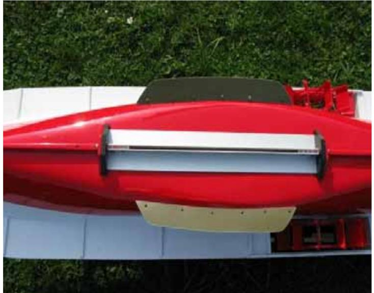
Befestigungsschiene für das Schwertkiel mit dem Bleigewicht.
