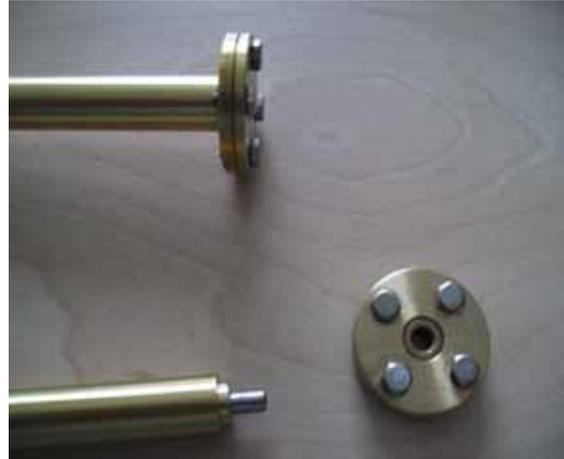
In die Antriebsplatte wurden Befestigungslöcher gebohrt um angefertigte Lagerböcke, die mit Einschraubgewinden versehen sind, anschrauben zu können.
