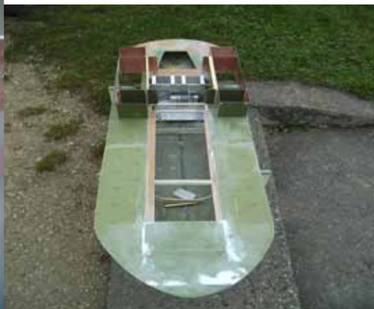
*Die Rumpfspanten und Leisten zur Deckauflage wurden so platziert, dass der Ein- und Ausbau der drei Grundplatten problemlos vonstatten gehen konnte und auch das Arbeiten mit Werkzeugen an den vorgesehenen Antriebsaggregaten keine Umstände bereitet.*
