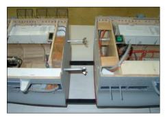
de und Scheinwerferstände angebaut. Jetzt konnten die Relingstützen an den Laufgängen angebracht und der Draht mit eingezogen werden. Die Stützen sind Messingätzteile mit drei Durchzügen. An-Bug und am Heck wurden die Reling ebenfalls verbaut.
