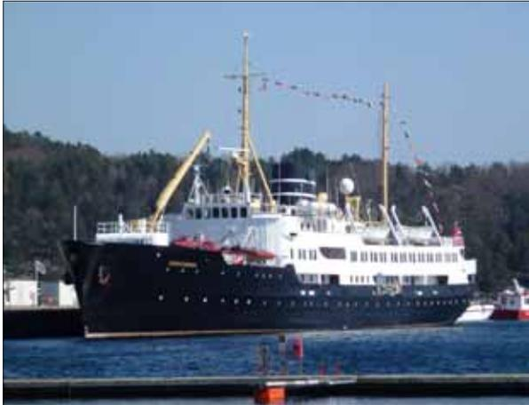
Heute möchte ich über ein außergewöhnliches Schiff, die MS Nordstjernen und die besonderen Reisen damit berichten. Die MS Nordstjernen wurde 1956 in Hamburg bei Blohm und Voss gebaut und hat 2191 BRT bei 80,77 m Länge und Kapazitäten für maximal 130 Passagiere.
