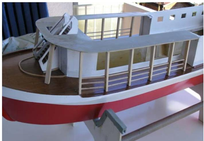
*Treppenaufgang und restauriertes Deck      GFK-Deckauflage und Deckstützen mit Reling
