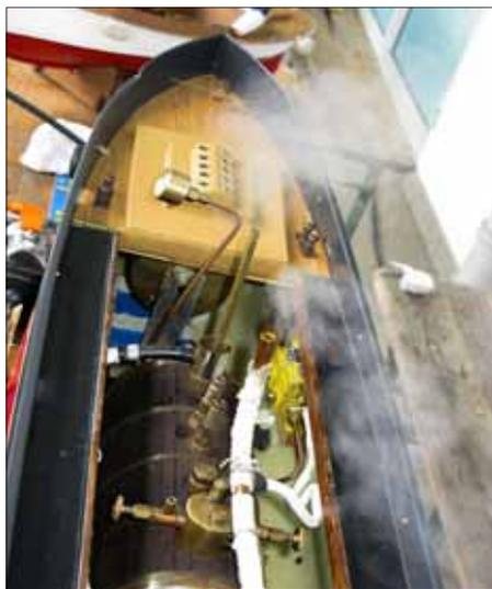
kann deshalb direkt nach oben, durch extra vorgesehene Öffnungen im gesamten Aufbau, entweichen. Die Aufbauten sind mit dem Aluprofil verklebt und werden als kompaktes Teil über den Süllrand gestülpt.
