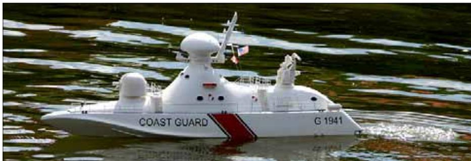
ne, Blaulicht und Suchscheinwerfer. Eine Wasserspritze in der Bugkanone ist vorbereitet, ebenso das Drehen beider Kanonen. Aus Gewichtsgründen habe ich das aber dann nicht realisiert. Einzige Schwierigkeit beim Bau war der exakte Einbau der Jetantriebe. Eine selbst gemachte CAD Zeichnung war da sehr hilfreich. Beide Jets werden synchron von 2 Servos gesteuert.
