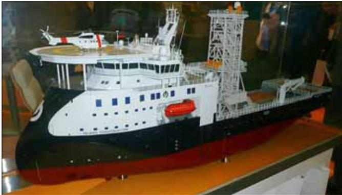
runde Formen und ragt hoch über die Wasserlinie hinaus. Dies ist nötig, da bei Seegang das Schiff nicht mehr so hart aufs Wasser schlägt, aber dafür weich und tief eintaucht. Der große Vorteil liegt in dem weichen Eintauchen
