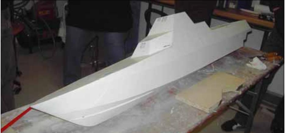
und dem Vorbild sehr nahe kommende Nachbauten der Firma Kehrer. Da das Modell im Maßstab 1:50 nur 33 mm Tiefgang hat, besteht nur die Chance, die kleinen 28 mm Jets einzubauen. Alle größeren hätten den zur Verfügung stehenden Bauraum gesprengt. Die Wahl des Motors fiel auf zwei Johnson 700 Neodym, die es ebenfalls bei Kehrer gibt, in Verbindung mit 2 Akkupacks aus je 12 NiMh-Zellen mit 3600 mAh.
