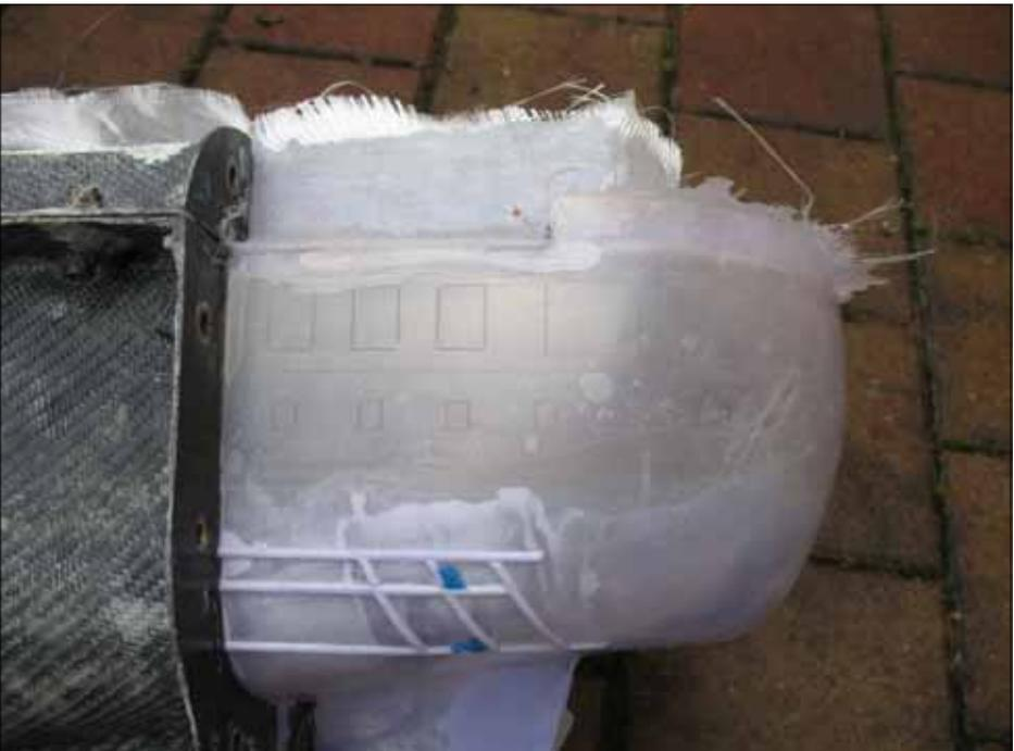
den. Das Ergebnis war: der Rumpf und auch der Aufbau müssen deutlich leichter werden und der Aufbau sollte auch noch als Transparentes Laminat entstehen.
