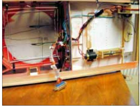
schussvorrichtung in Arbeit, um eventuell "havarierte" Modelle an den Haken zu nehmen. Der durch ein Servo betätigte Schlepphaken ist schon am Heckspiegel angebracht.
