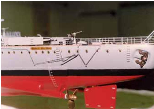
Messing, außer die der schweren Artillerie. Diese Rohre wurden auf der Intermodellbau in Dortmund gekauft und sind aus Aluminium. Für Sonderfunktionen ist in diesen Rumpf natürlich eine Menge Platz. Die großen Geschütztürme, die Torpedorohre und das Katapult mit dem Bordflugzeug lassen sich schwenken. Der Anker
